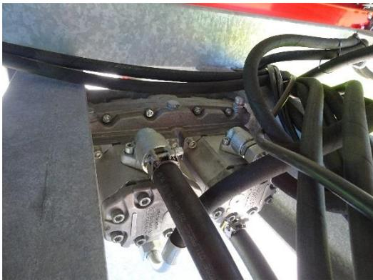
Die zwei Hydraulikpumpen treiben den Kratzboden, das Querband, sowie die Dosierwalzen hinten und vorne hydraulisch an. Die Dosierwalzen und der Kratzboden sind gegen Überlast abgesichert.
