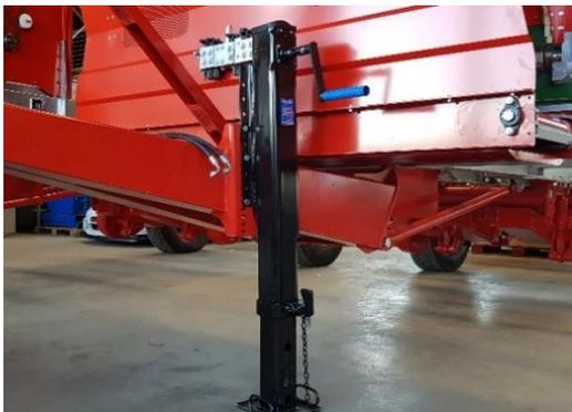
Die Zugdeichsel ist angeschraubt und ist infolgedessen an die benötigte Höhe anpassbar. Dank der schmalen Gestaltung kann die für Oben- oder Untenanhängung genutzt werden. Die Gelenkwelle ist so angeordnet, dass für die Unterlenker ausreichend Platz vorhanden ist.
