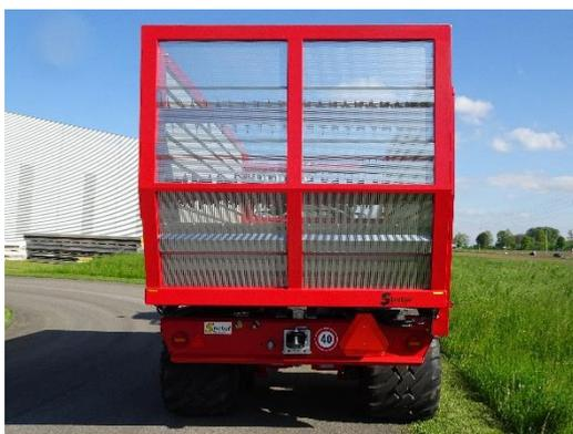
Der widerstandsfähige Unterfahrerschutz schützt das Fahrzeug. Damit beim Rückwärts abladen kein Mais auf dem Lichterbalken liegen bleibt, wurde dieses spezielle Profil gewählt.
