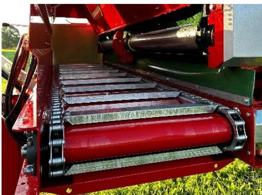
Das 60cm breite Querförderband mit grosser Fallstufe, sowie der geräumigen Auswurföffnung, wurden für eine beachtliche Abladeleistung gebaut. Die Querbandkette gleitet über Kunststoffführungen, dadurch können die Mitnehmer den Wageninhalt mühelos wegräumen. Durch den Gelenkwellenantrieb beim Querband ist der Antriebsmotor ausserhalb der Gefahrenzone.
