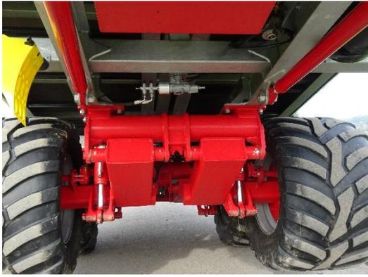
Das 16t Tandemfahrwerk ermöglicht auch in Hanglagen Standsicherheit. Die grosszügige Bereifung garantiert Bodenschonung. Die grossdimensionierten Bremsen (400x120) wirken auf alle vier Räder.
