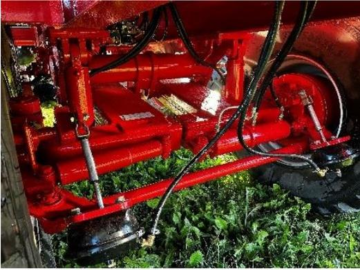
Das hydr. 20t Tandemfahrwerk ermöglicht auch in Hanglagen Standsicherheit. Mit dem ausgeklügelten System lassen sich Reifenpannen ohne Winde und sogar auf dem Feld erledigen. Die grosszügige Bereifung garantiert Bodenschonung. Die grossdimensionierten Bremsen wirken auf alle vier Räder.
