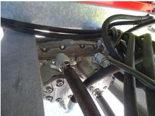
Die zwei Hydraulikpumpen treiben den Kratzboden, das Querband, sowie die Dosierwalzen hinten und vorne hydraulisch an. Mit dem Verzicht auf Tandempumpen, haben die zwei Einzelpumpen Kostenvorteile. Die Dosierwalzen und der Kratzboden sind gegen Überlast abgesichert.
