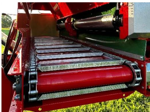
Der Kratzboden wird mittig angetrieben, so dass es eine gleichmässige Kraftverteilung der Welle ergibt und somit rechts und links die Auswurföffnung nicht beeinträchtigt.
